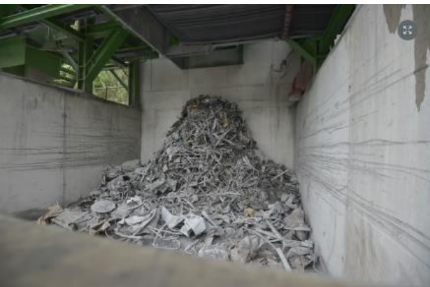
Aus der Schlacke werden grosse Metallmengen herausgefiltert.
